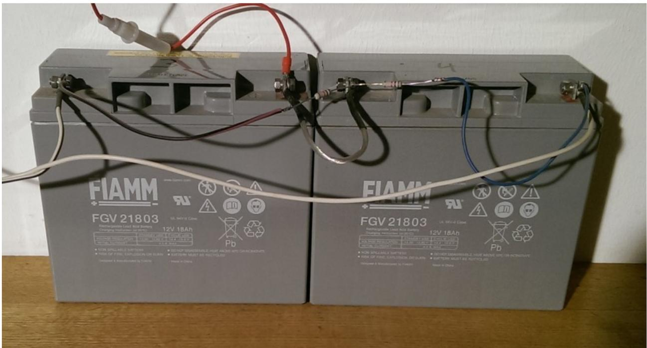
Der Testbetrieb unter diesen Bedingungen mit zwei Bleigelakkumulatoren aus einer USV brachte überraschend gute Ergebnisse. Nach zwei Jahren konnte ich noch 70 % der ursprünglichen Kapazität messen
