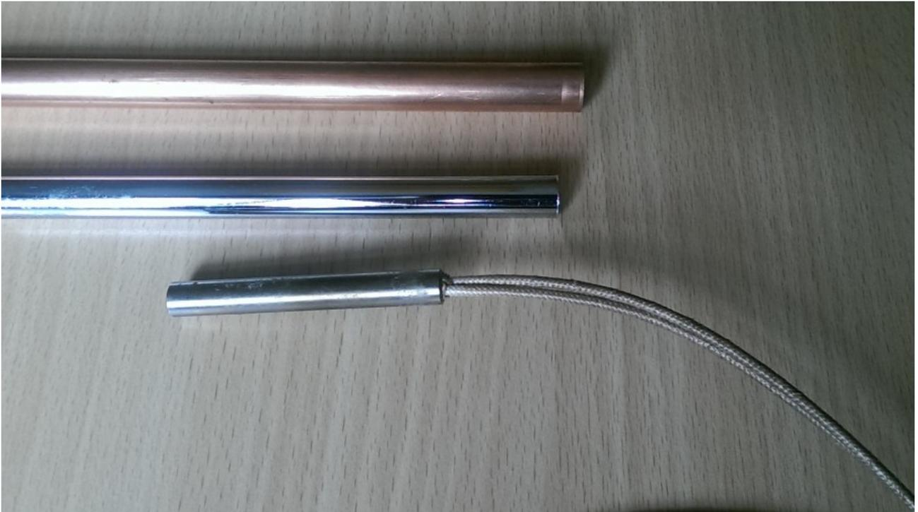
Im Baumarkt gibt es 12 mm Kupferrohr, das einen Innendurchmesser von etwa 10 mm hat, und es gibt 10 mm Rohrstücke, die für die Montage von Mischbatterien u.ä. an Eckventile gedacht sind. Die sind ebenfalls aus Kupfer und haben einen Innendurchmesser von etwa 8 mm. Wenn alle Schnittstellen gut entgratet sind, passt alles ineinander und die Wärmeleitfähigkeit von Kupfer ist ideal.
