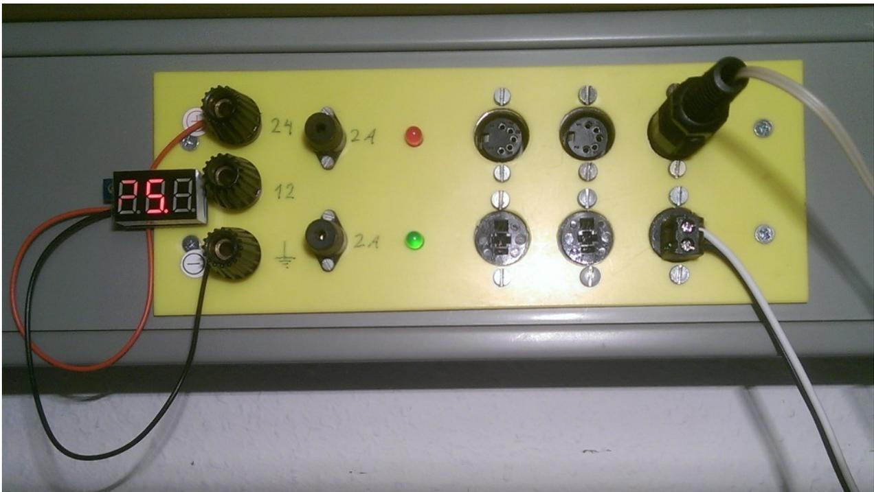
Bei der Auswahl der Leitungen muss unbedingt beachtet werden, dass die Leitungswiderstände bei den relativ kleinen Spannungen kritischer sind, als bei den üblichen 230 Volt. Wenn 5 Ampere einen Widerstand von 1 Ohm überwinden müssen, bleiben 5 Volt im Kabel „hängen“. Bei 230 Volt kommen dann nur noch 225 Volt an. Das kann man vernachlässigen, aber wenn von 12 Volt nur noch 7 Volt da sind, geht nichts mehr.
