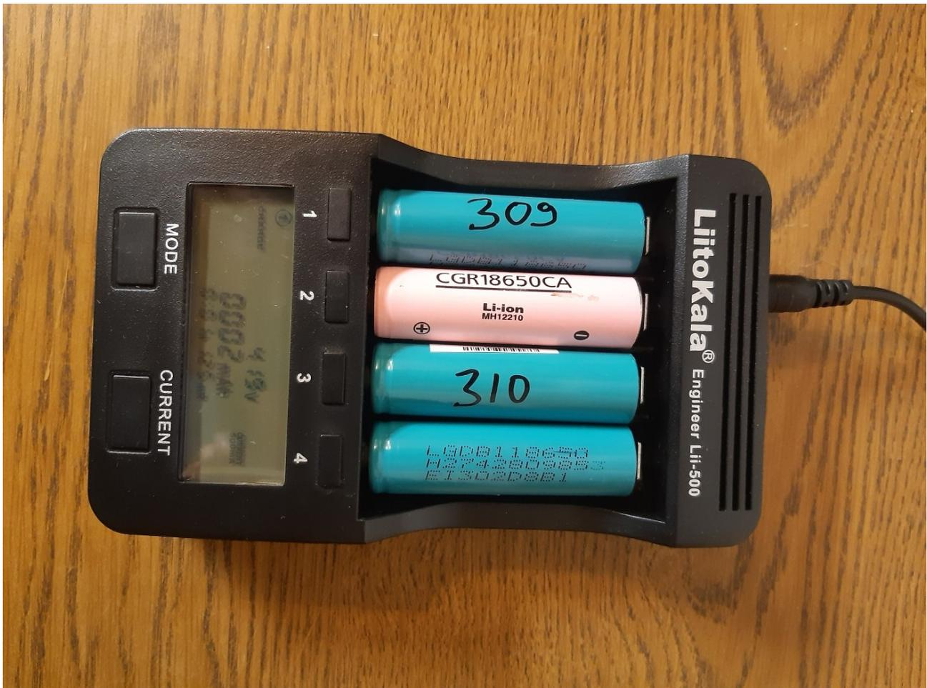
Nach der ersten Ladung wurden die Zellen einzeln gelagert und die Selbstentladung beobachtet. Der erste Wert wurde etwa 1 Stunde nach der Ladung gemessen und in die Tabelle eingetragen. Der zweite Wert nach 24 Stunden und der dritte Wert nach 14 Tagen. Bei Abweichung der Spannung zwischen zwei Messungen, also entweder schon nach einem Tag oder zwischen der zweiten und dritten Messung, die größer als 0,05 Volt war, wurde die entsprechende Zelle ebenfalls aussortiert.
