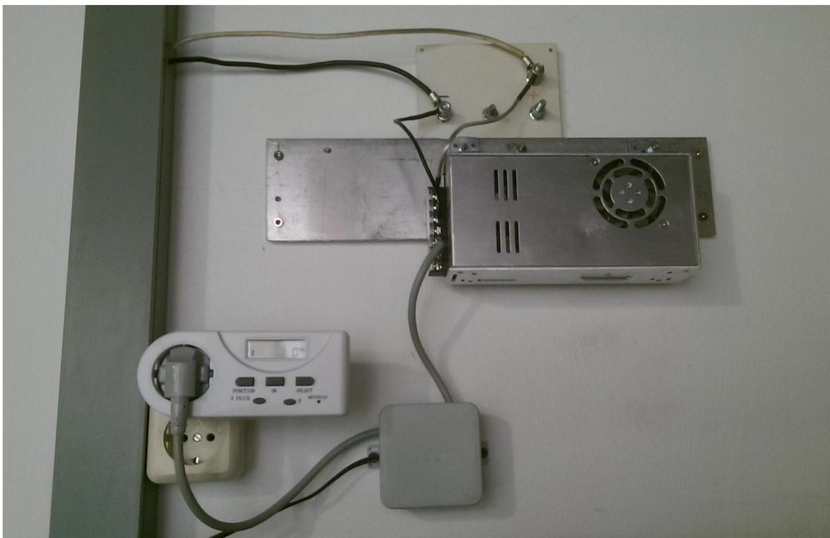
Das Ersatzstromnetzteil wird mit einem Relais eingeschaltet, das sich in einer Verteilerdose befindet. Die Steuerspannung für das Relais wird durch den Mikrocontroller aktiviert, wenn die Batteriespannung den Wert von 24,8 Volt unterschreitet.
